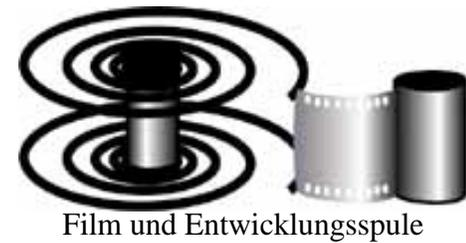
Licht aus: Die Filmpatrone wird mit dem Flaschenöffner "geköpft" und der Film samt Spule entnommen. Im Dunkeln wird die Filmflasche vorsichtig abgeschnitten und die Ecken des Filmes abgerundet, damit das Einspulen in die Filmhalterung leichter fällt. Dabei ist darauf zu achten, daß nur die ersten zehn Zentimeter des Filmes berührt werden, da auf dem Filmanfang noch keine Bilder sind. Sollte sich der Film sehr stark einrollen, kann der Filmanfang leicht eingeknickt werden.
